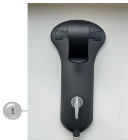
Obrázek 13 – 1 - Bezpečnostní klíč v ručním ovladači
