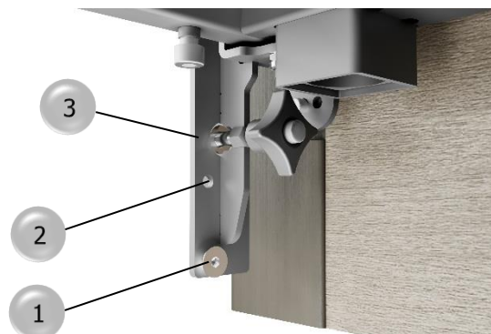
Obrázek 28 – 1 - šroub se zapuštěnou hlavou ve standardní poloze, 2 - závit pro zvýšenou polohu, 3 - konzola
